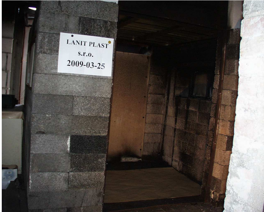
Pohled na zkušební vzorek č. 1 před zkouškou
